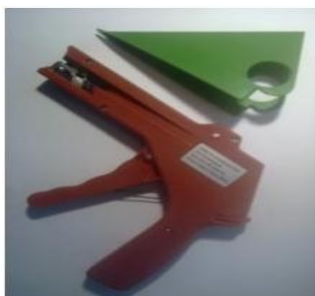
Figure 7: Ustensiles de fixation et d'insertion de câbles
